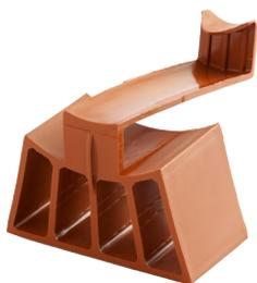
in polipropilene copolimero stabilizzato ai raggi U.V.A.: elemento di rialzo ed ancoraggio, da applicare sul retro di ogni coppo canale. La staffa a Z permette di agganciare il coppo canale successivo retrostante, consentendo così la creazione di una maglia catenaria.
