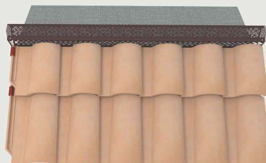
Chiusura degli spazi con l'ultima fila di tegole per arrivare in aderenza all'elemento di colmo
