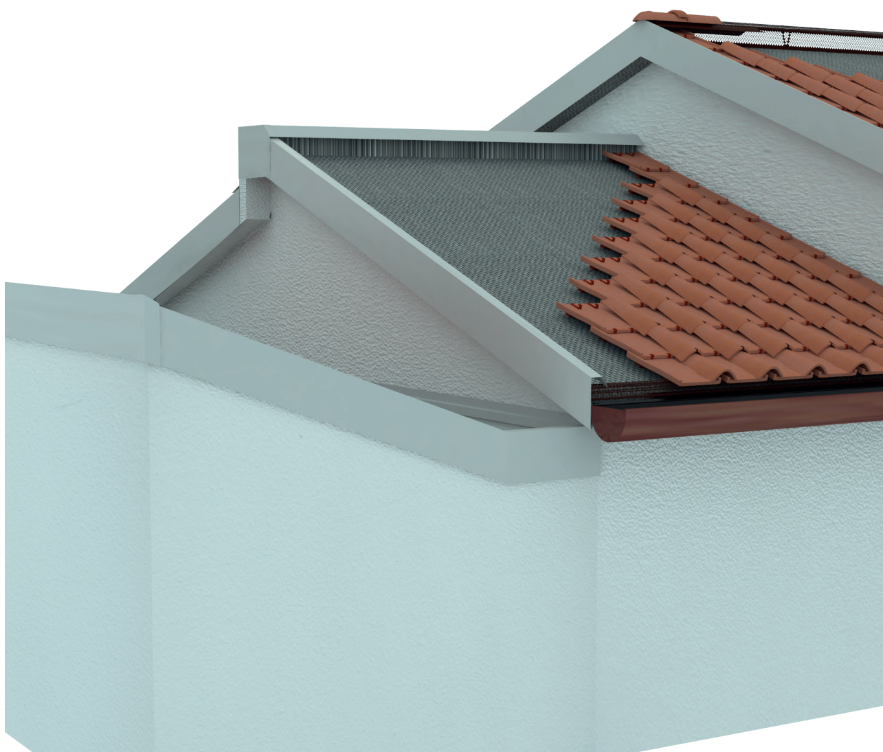
Vista delle scossaline di chiusura laterale delle diverse tipologie di falda
