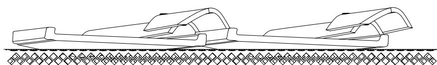
Vista prospettica dell'elemento di displuvio DCT
