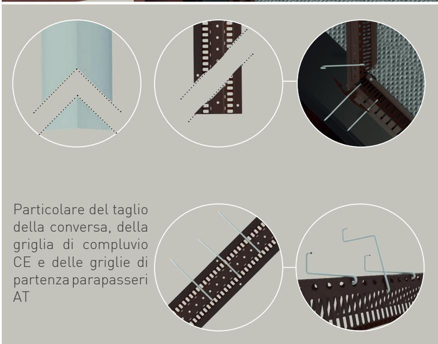
Particolare del taglio della conversa, della griglia di compluvio CE e delle griglie di partenza parapasseri AT
